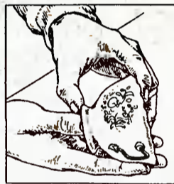
Рис. 1. Проволока согнута по контуру новой ручки.
