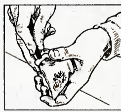
Рис. 3. Аккуратно обработайте ручку абразивным инструментом.
